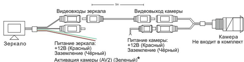
\* Для активации видеовыхода камеры заднего вида (AV2) необходимо подать +12 В на активационный провод (например от фонаря заднего хода). При выключении видеовыхода AV2, возможно кратковременное включение видеовыхода AV1 для проверки наличия сигнала.
